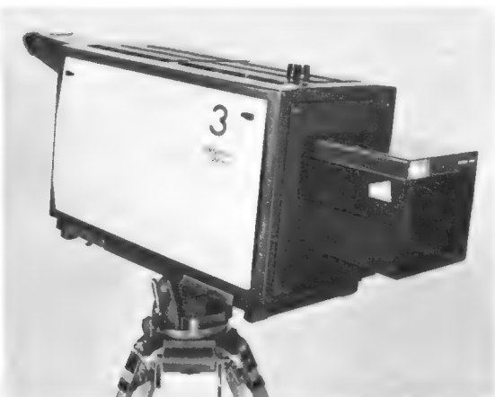
Bild 1. Farbfernsehkamera KC 33 OK 9 A der Fernseh GmbH mit drei 3-Zoll-Image-Orthikon-Röhren und Vario-Optik Varolet V mit Range-Extender und Servosteuerung
